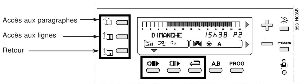
Les touches d'accès aux réglages et mesures , et les touches de programmation , , , situées sous le volet permettent la modification des programmes et le réglage de différents paramètres.
