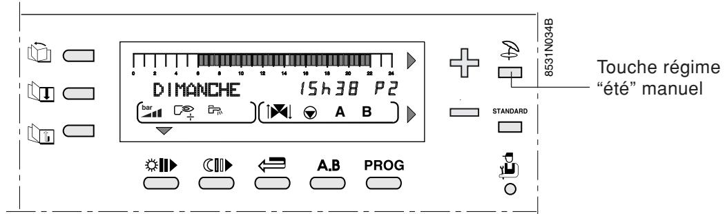
Le régime "été" permet la coupure du chauffage en été tout en permettant le réchauffage de l'eau chaude sanitaire.
