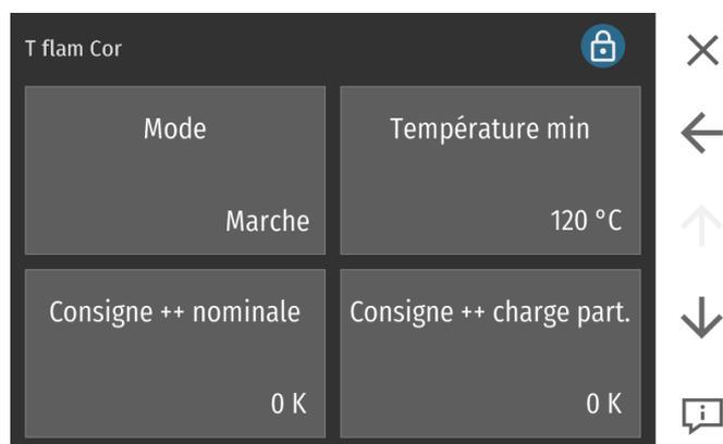
L'activation de la sonde flamme est uniquement possible si une sonde flamme est connectée sur l'automate de combustion.
