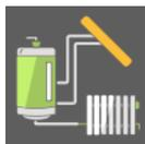
Cette fonction permet de décharger l'excédent de chaleur solaire dans un circuit de chauffage /ballon ECS spécifique. Elle est visible en présence d'un ballon tampon et de capteurs solaires.
