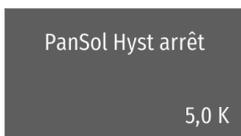
Lorsque la différence de température entre les capteurs et l'accumulateur est inférieure à cette valeur, la pompe solaire s'arrête.
