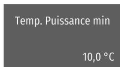
Lorsque la température extérieure dépasse cette limite, la puissance de la chaudière est minimale.
