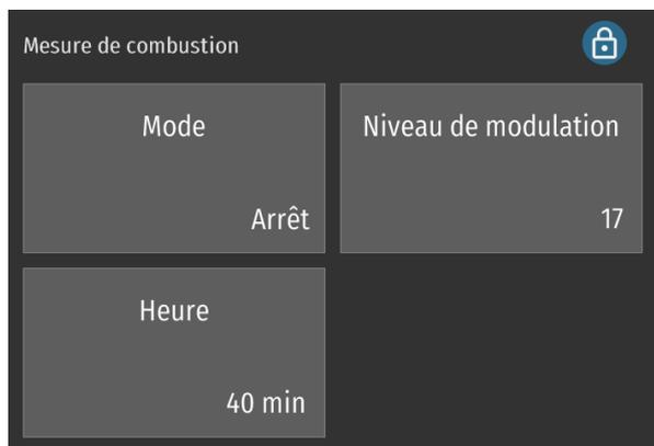
Après activation de la fonction mesure de combustion, la chaudière démarre.
