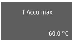
Après avoir dépassé T Accu Max, le circuit solaire est arrêté. La température est mesurée par le capteur de limitation réglé en mise en route.
