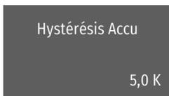
Le circuit solaire ne redémarre que si la température mesurée par la sonde de limitation baisse de Hystérésis Accu. Cette hystérésis évite que la pompe soit arrêtée et relancée de façon intempestive.
