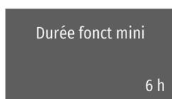
Représente la durée minimale de fonctionnement du brûleur qui doit s'être écoulée entre deux ramonages. Valeur réglable.
