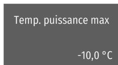
Lorsque la température extérieure passe sous cette limite, la puissance de la chaudière est maximale, dans la limite de la puissance définie en recherche auto. Entre ces deux seuils la puissance chaudière effective correspond à la moyenne entre puissance nominale réglée en recherche auto et puissance mini chaudière.
