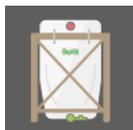
L'icône remplissage (silo) permet de déclarer un remplissage. En choisissant poids max, vous remplissez le silo à sa capacité max. La saisie manuelle permet de spécifier un poids précis. On peut saisir une valeur négative pour corriger une erreur de saisie.
