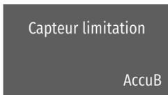
Choisissez ici le capteur qui coupera le circuit solaire au dépassement de la température maximale de ballon. Vous ne pouvez choisir que les capteurs installés et détectés entre BT Haut, BT Milieu, Accu Bas et ECS.
